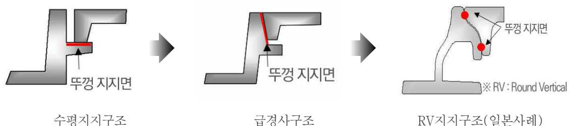
[그림 5.1] 맨홀(작업구)뚜껑의 지지구조 변화
