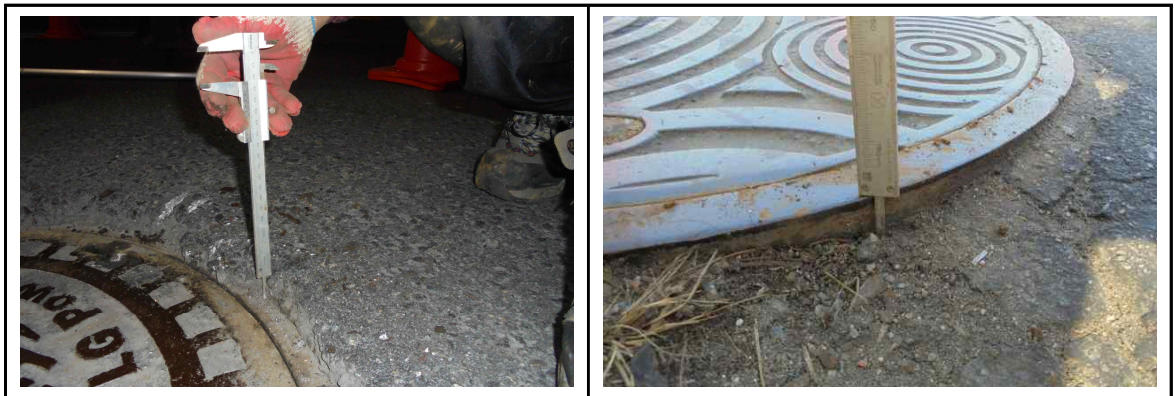
〔그림3.1〕 뚜껑면과 포장면의 단차조사 예시
