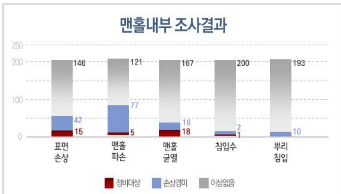
[그림 3.6] 맨홀(작업구)내부 조사결과
